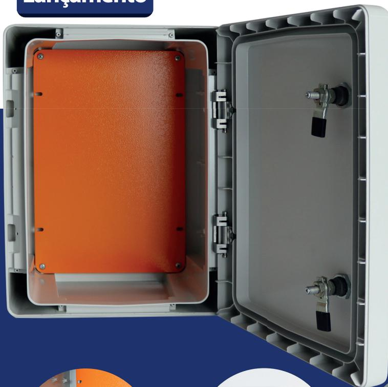
A caixa possui diversos ressaltos em sua lateral, permitindo várias configurações de fixação para a placa de montagem e acessórios. Além disso, possui angulações tanto na área externa quanto na região do fechamento da porta que promovem o escoamento da água, evitando acúmulos de partículas que possam comprometer a sua proteção IP. Possui dobradiças metálicas com pinos móveis para facilidade na retirada ou montagem da porta e inserto metálico M8 para fixação do produto em postes ou paredes.
