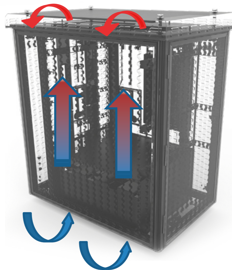
DIAGRAMA DE FLUXO DE AR NO ARMÁRIO
