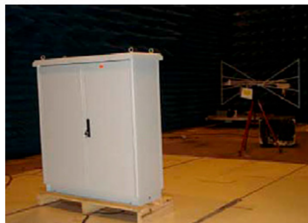
CABINE EM TESTE ELETROMAGNÉTICO
