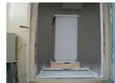
Cabine de teste de estanqueidade
